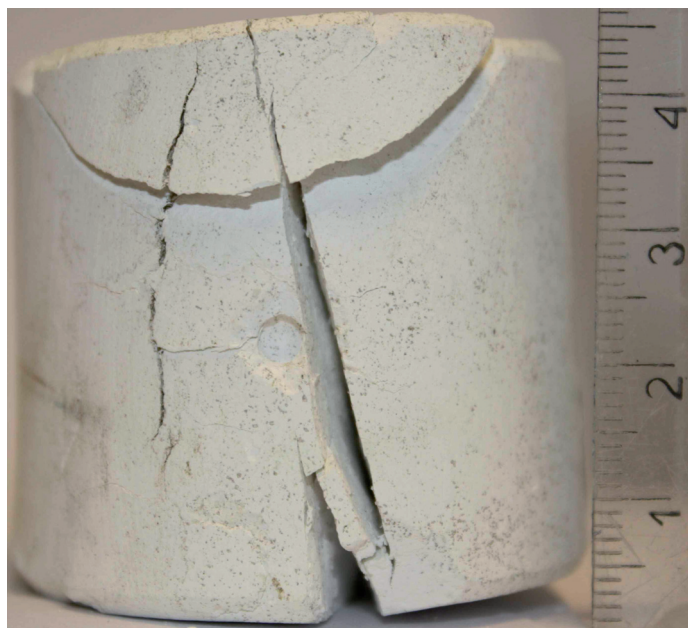
Rys. 7. Próbką wapienia karbońskiego po dysocjacji termicznej z widocznymi spękaniem stanowiącymi drogi szybkiej dyfuzji ditlenku węgla oraz okrągłą wklęsłością, w której zamocowana była termopara do pomiaru temperatury powierzchni próbki: masa początkowa próbki m_0 = 187,01 g, stopień przereagowania X \cong 43,5\% , d_0 = 45,21 mm (odchylenie standardowe 0,15 mm), d_0/h_0 = 1,026 , gdzie h_0 jest wysokością próbki
